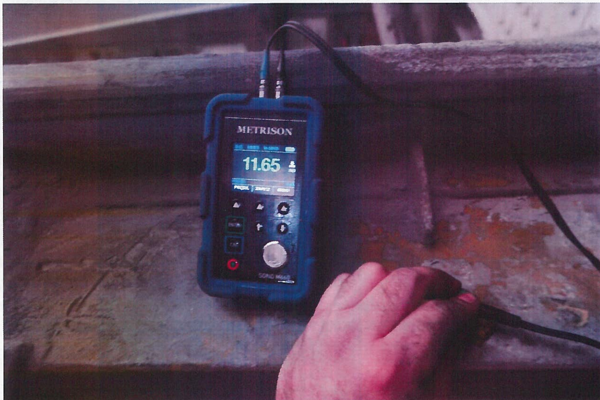
Fot. 7.5. Pomiary grubości metodą UTT.
