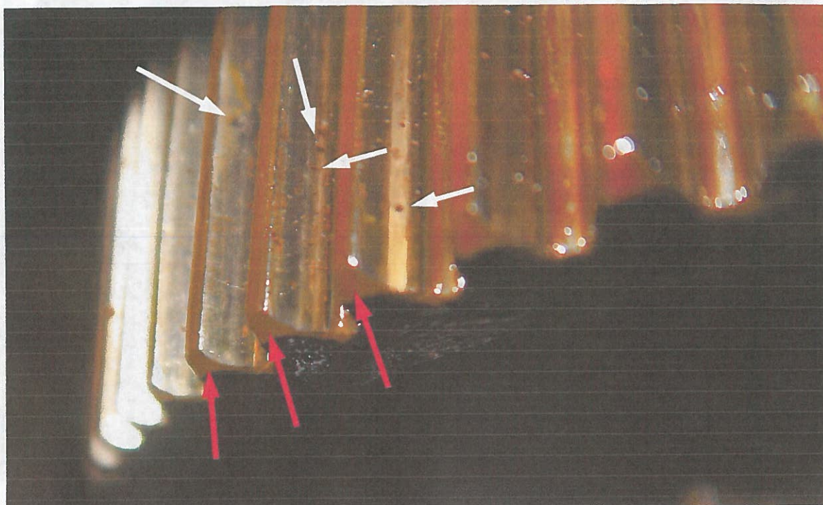
Fot. 8.2. Zużyte zęby – podcięcia (wskaźniki koloru czerwonego) oraz pitting/wykruszenia (wskaźniki koloru białego) -reduktor przy podporze prawej.
